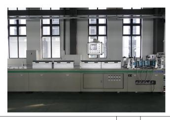
采用履带式牵引机, 压紧力采用气动压紧。
